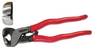
In acciaio forgiato con riporto in metallo duro sui taglienti. Adatte per asportare materiale da piastrelle di rivestimento smaltate o vetrificate, gres, ecc. Con taglienti trasversali asimmetrici per tagli rasi. Lunghezza mm 200.
